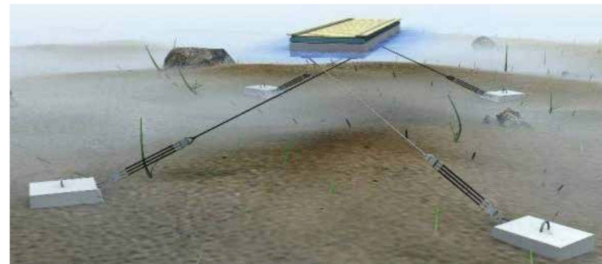
Figur 3.5. Forankret flydebro, her vist med Seaflex, som kan erstatte kæder, men er en dyrere løsning.
