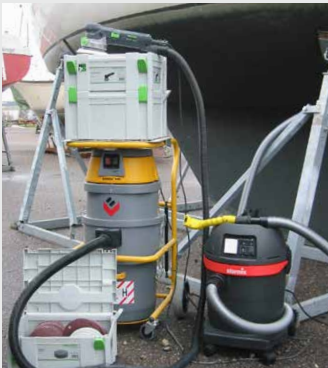
For at hjælpe bådejerne opfordres havnene til at anskaffe egnet materiel til hhv. afdækning og opsamling, så rester af bundmaling og slibestøv i forbindelse med påføring og slibning kan opsamles.
